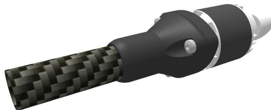
Dieser Spalt kann später genutzt werden, um den Schubwinkel einzustellen. Dazu werden die gegenüberliegenden Schrauben ganz leicht gelöst und die Schraube am Spalt etwas fester angezogen. Schiebe das CFK-Rohr mit Motor wieder in die Klemmen im Rumpf. Prüfe, dass die Ecke mit dem Spalt gerade nach unten zeigt.
