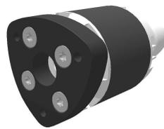
Lockere die Schrauben und ziehe das CFK-Rohr mit Motorhalter aus dem Rumpf. Schraube den Motor mit der Motorplatte an den Motorhalter. Die Motorplatte sollte flach auf dem Motorhalter sitzen und an einer Ecke einen kleinen Spalt aufweisen.
